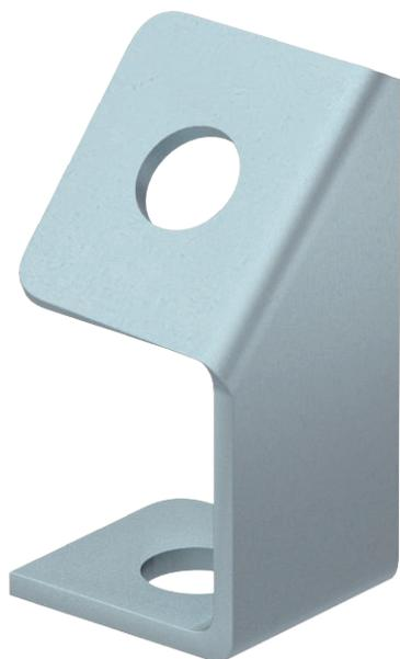
Соединительная скоба для наклонной фиксации стержня с резьбой при настенном монтаже стандартных кабеленесущих систем (листовых кабельных лотков и кабельных лотков лестничного типа), предусмотрена для прокладки кабельных трасс повышенной живучести согласно DIN 4102 часть 12.
