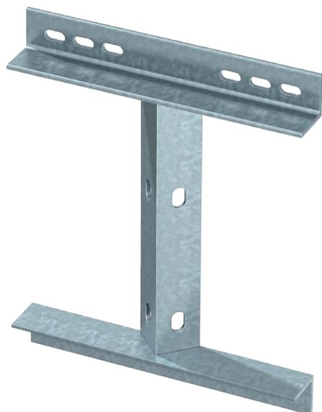
Адаптерная пластина с продольными отверстиями для универсального крепления на вертикальных стальных держателях и на стенах. На адаптерную пластину могут прикручиваться настенные / опорные кронштейны с углом 45°.
