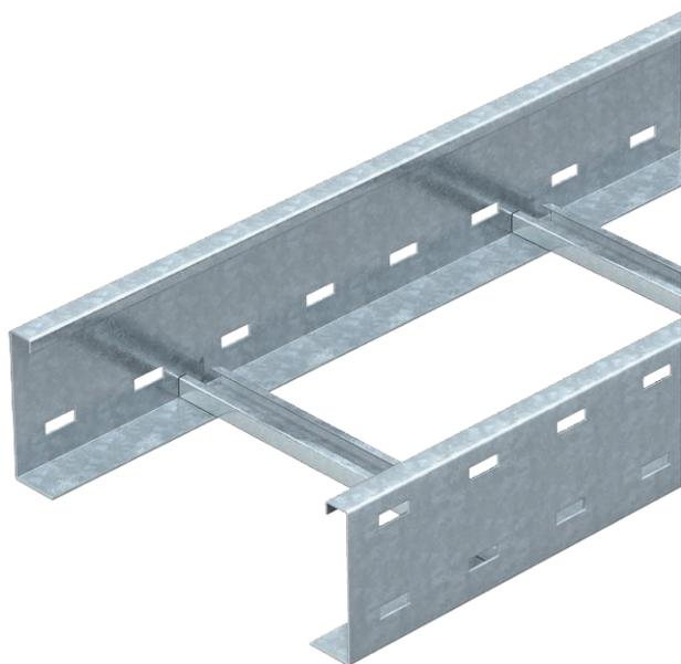
Кабельный лоток лестничного типа для больших расстояний с перфорированной боковой перекладиной с боковыми стенками высотой 110 мм. Крепление кабелей и проводов при помощи зажимной скобы, тип 2056.
