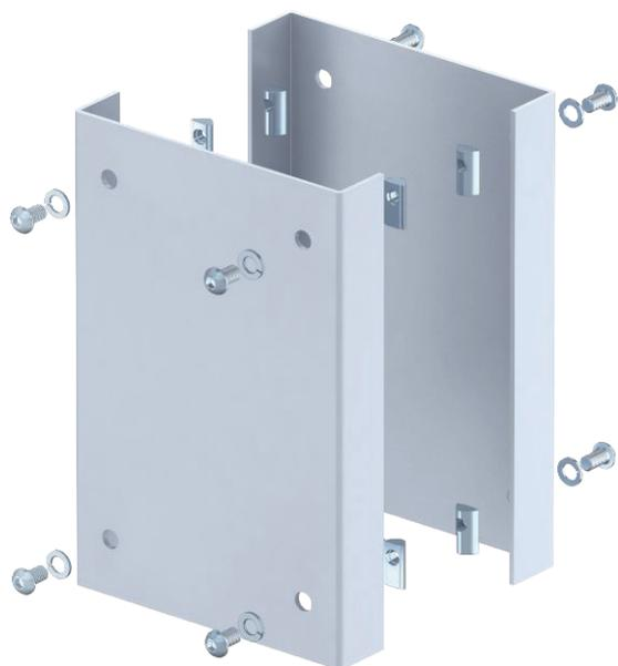
Защитная пластина для предотвращения повреждения колонны в области пола. В комплект поставки входят 2 U-образных защитных профиля из листовой стали толщиной 3 мм и 8 крепежных болтов с вкладышами для крепления в профиль колонны.
