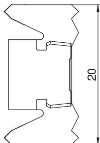
Конструкция Зажимная пружина
