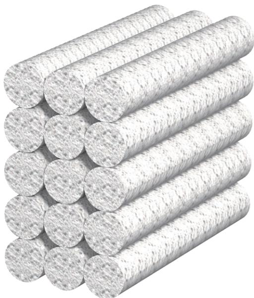
Звукоизоляционный барьер служит для понижения уровня передаваемого звука, например, при прохождении короба через отверстия в стене между двумя офисами. Звукоизоляционный барьер состоит из минеральной ваты, которая при поставке имеет диаметр прим. 30 мм и длину примерно 300 мм. При монтаже материал не следует сильно сжимать.
