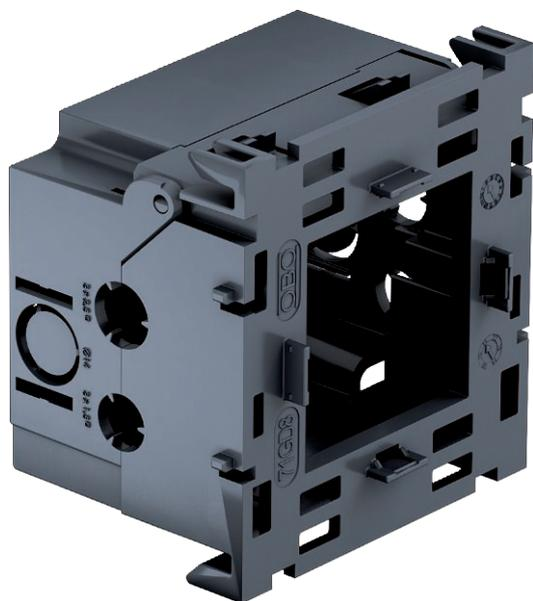
Монтажная коробка для одинарной розетки серии Modul 45, с фиксатором, расположенном сверху, со съемным основанием для быстрого подключения проводов, с отверстиями для кабеля диаметром до 14 мм.
