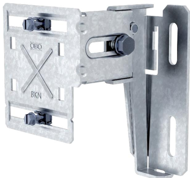
Крепежная консоль для монтажа кабельных коробов под подоконником и в качестве опоры для конвекционных решеток. Крепежные консоли подходят для всех кабельных коробов Rapid 80 типа GK, GS и GA. Для монтажа кабельных коробов GK из пластика требуется соответствующий адаптер настенной консоли. Для монтажа двойного короба тип GS-D70170 и GS-D90170, а также для коробов GS с номинальной шириной 210 мм требуется соединительный профиль.
