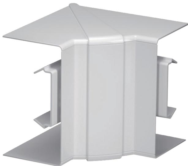
Регулируемый внутренний угол из пластика PC/ABS (без содержания галогенов) для изменения направления кабельных коробов Rapid 80 GK, GS и GA. Фасонные детали регулируются под углом 85° - 95° и применяются для симметричных и асимметричных коробов.
