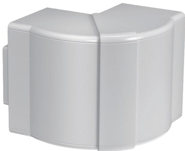
Регулируемый внешний угол из пластика PC/ABS (без содержания галогенов) для изменения направления кабельных коробов Rapid 80 GK, GS и GA. Фасонные детали регулируются под углом 80° - 100° и применяются для симметричных и асимметричных коробов.
