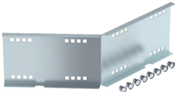
Горизонтальный угловой соединитель 45° для кабельных лотков и кабельных лотков лестничного типа для больших расстояний (высота боковой стенки: 160 мм).
