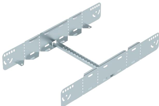
Мультифункциональный соединитель для соединения лестничных лотков с боковой стенкой высотой 110 мм. Благодаря соединителю можно создавать симметричные и асимметричные переходники и угловые секции 0-60°.
