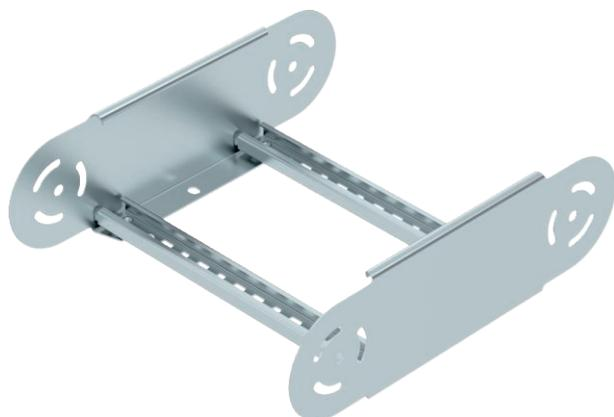
Шарнирный соединитель с приваренными перекладинами, для всех кабельных лотков лестничного типа с боковой стенкой высотой 110 мм.
