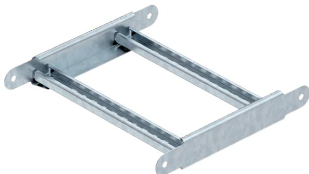
Шарнирный соединитель с приваренными перекладинами для всех кабельных лотков лестничного типа с боковой стенкой высотой 45 мм.
