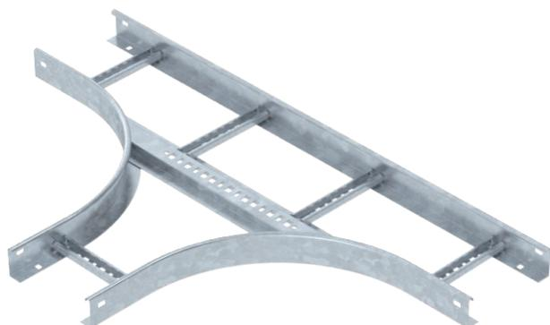
T-образная секция, горизонтальная, с приваренной перекладиной для монтажа на любых кабельных лотках лестничного типа с боковыми стенками высотой 60 мм.
