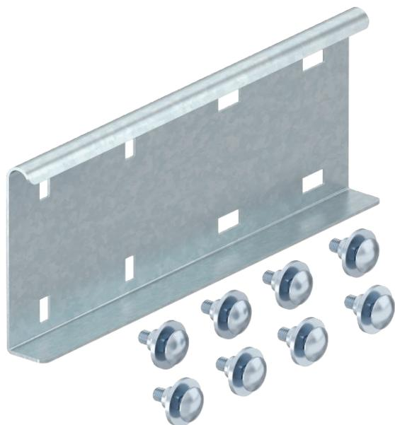
Соединитель для выравнивания кабельного лотка лестничного типа при термически обусловленном продольном расширении. Момент затяжки самофиксирующихся болтов на подвижной стороне составляет 5 Нм.
