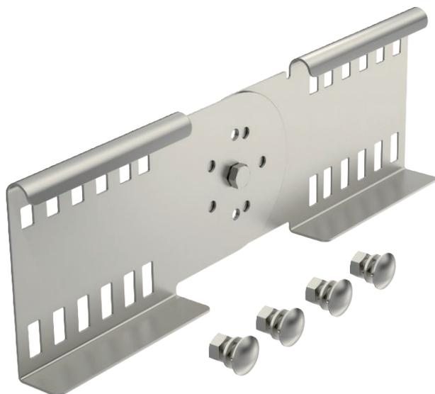
Шарнирный соединитель выступает в качестве внешнего крепления для фиксации кабельных лотков лестничного типа и фасонных деталей с высотой боковой стенки 110 мм и сквозной перфорацией стенки. Уголки регулируются по вертикали.
