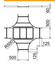
500,00 мм Ширина 60,00 мм Высота Высота боковой стенки 60,00 мм Размер В 500,00 мм Размер R 500,00 мм Конструкция перекладин Профиль неперфорированный Конструкция бокового Плоский профиль профиля 1,50 мм Толщина борта Предназначено для поддержания функций Нержавеющая сталь, протравленная Исполнение для больших расстояний
