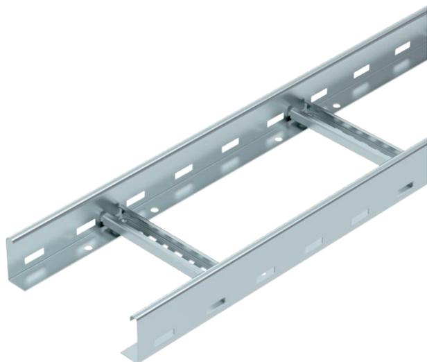
Кабельный лоток лестничного типа с боковыми стенками высотой 60 мм, с приваренными, открытыми вверх перекладинами С30. Загнутая боковая стенка для усиления конструкции и защиты кромок. Крепление на кронштейн производится с помощью фиксаторов типа LKS 40. Размер шлица в поперечине составляет 16,5 мм, подходящий тип зажимной скобы 2056.
