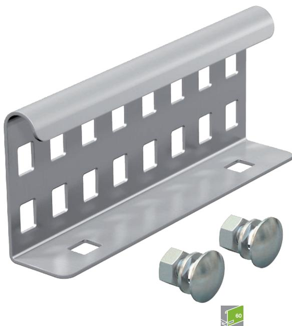
Продольный соединитель в качестве внешнего крепления для фиксации кабельных лотков лестничного типа и фасонных деталей с высотой боковой стенки 60 мм и сквозной перфорацией стенки.
