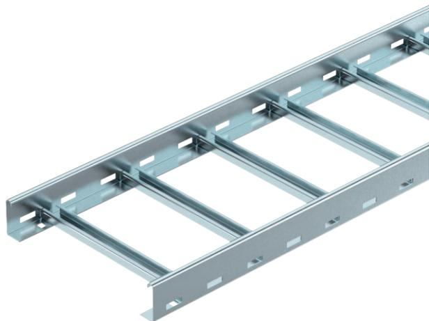
Кабельный лестничный лоток для горизонтальной прокладки кабелей и проводов. Может использоваться в качестве стандартной несущей конструкции для повышения живучести электрических конструкций в соответствии с DIN 4102 часть 12. Классы огнестойкости от E30 до E90 с перекладинами из С-образного профиля, закрепленного на заклепках и расположенного открытой стороной вверх
