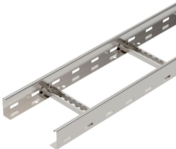
Kabelleiter in Seitenhöhe 60 mm mit eingeschweißten, nach oben offenen C30- Profil Sprossen. Загнутая боковая стенка для усиления конструкции и защиты кромок. Крепление на кронштейн производится с помощью фиксаторов типа LKS 40. Размер шлица в поперечине составляет 16,5 мм, подходящий тип зажимной скобы 2056.
