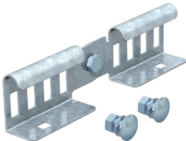
Шарнирный соединитель выступает в качестве внешнего крепления для фиксации кабельных лотков лестничного типа и фасонных деталей с высотой боковой стенки 45 мм и сквозной перфорацией стенки. Уголки регулируются по вертикали.
