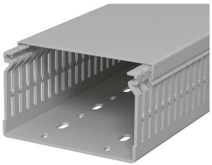
Распределительный кабельный короб с крышкой, с перфорированным основанием; сужения в боковых стенках предотвращают выпадение проводов. Номинальный размер системного отверстия соответствует внутреннему размеру короба. Специальные размеры по запросу.
