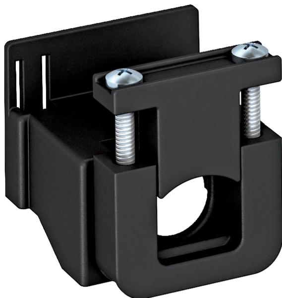
Фиксатор для разгрузки кабеля от натяжения, устанавливаемый с боковой стороны, применяется для розеток 0° с защитным контактом и заземляющим стержнем серии Modul 45, используется для крепления 3-х жильных проводов максимум Ø 10 мм.
