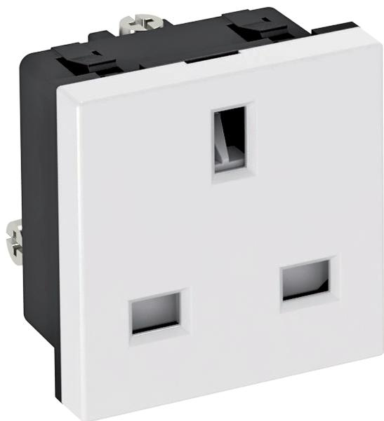
Одинарная розетка 0°, британский стандарт, соответствует стандарту BS 1363, с защитными шторками, с винтовыми клеммами, 2-полюсная, 13 А, 250 V $\sim$ .
