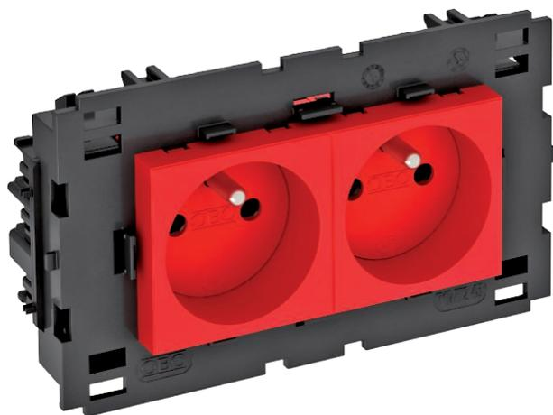
Розетка с заземляющим стержнем, двойная 0°, с боковым подключением, с защитными шторками, с автоматическими клеммами, 2-полюсная, 16 А, 250 V~, соединительные клеммы соответствуют стандарту IEC 60884-1, подходит для установки в кабельных коробах Rapid 80.
