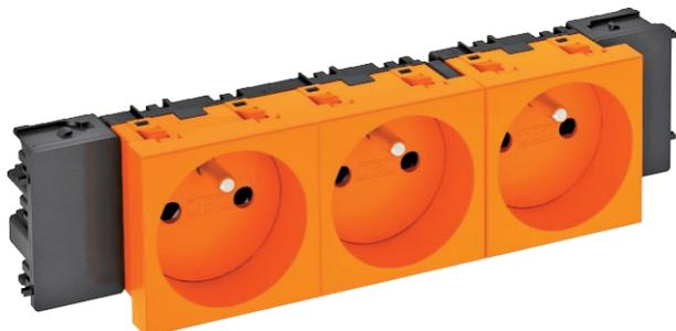
Розетка с заземляющим стержнем, тройная 0°, с боковым подключением, с защитными шторками, с автоматическими клеммами, 2-полюсная, 16 А, 250 V~, соединительные клеммы соответствуют стандарту IEC 60884-1, подходит для установки в кабельных коробах Rapid 45.
