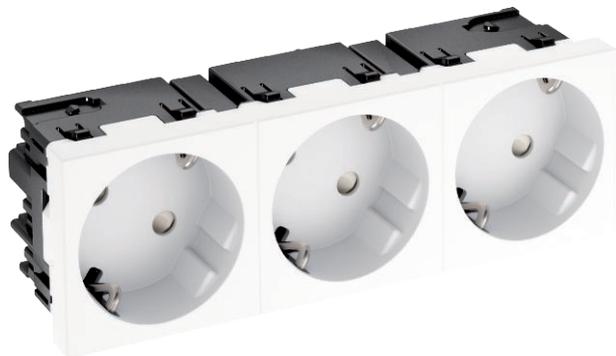
Розетка с заземляющим контактом одинарная 33°, с повышенной защитой от прикосновений, со штекерными зажимами, 2-полюсная, 16 А, 250 V~, с соединительными клеммами согласно IEC 60884-1.
