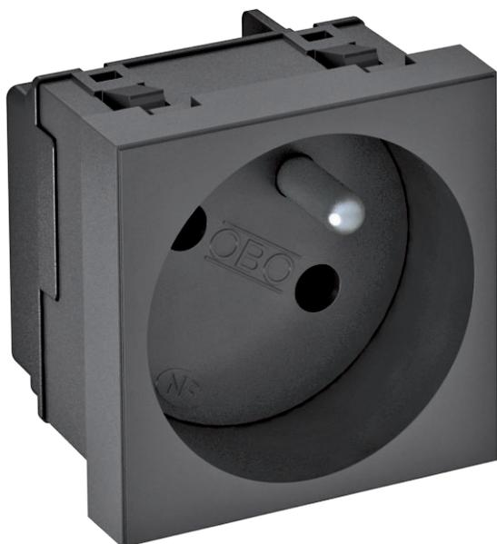
Розетка со стержнем заземления одинарная 33°, с защитными шторками, с автоматическими клеммами, 2-полюсная, 16 А, 250 V~, автоматические клеммы соответствуют стандарту ГОСТ Р 51322.1-2001 МЭК 60884-1:2006.
