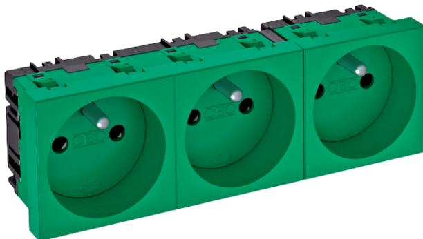
Розетка с заземляющим стержнем тройная 0°, с защитными шторками, с автоматическими клеммами, 2-полюсная, 16 А, 250 V~, автоматические клеммы соответствуют стандарту ГОСТ Р51322.1-2001 МЭК 60884-1:2006.
