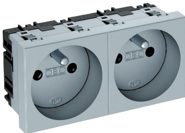
Розетка с заземляющим стержнем одинарная 0°, с защитными шторками, с автоматическими клеммами, 2-полюсная, 16 А, 250 В~, автоматические клеммы соответствуют стандарту ГОСТ Р51322.1-2001 МЭК 60884-1:2006.
