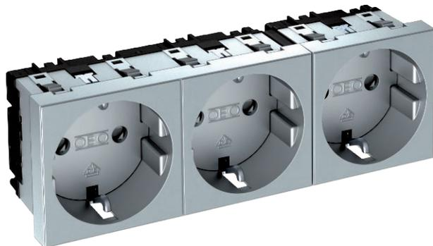
Розетка с заземляющим контактом, тройная 0°, с защитными шторками, с автоматическими клеммами, 2-полюсная, 16 А, 250 V~, автоматические клеммы соответствуют стандарту ГОСТ Р51322.1-2001 МЭК 60884-1:2006.
