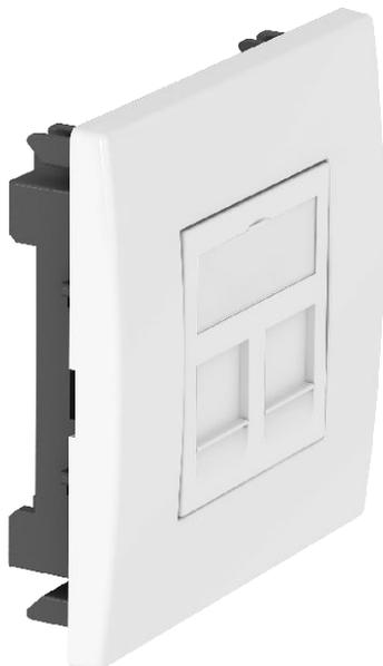
Корпус компьютерной розетки для двух телекоммуникационных модулей типа А, подходит для установки в кабельный короб Rapid 80 и электромонтажные колонны ISS. Корпус компьютерной розетки типа А подходит для следующих телекоммуникационных модулей: AMP TYCO (без пылезащитного колпачка) серия SL 110Connect и серия SL Toolless; Brand-Rex: модули с обозначением в конце артикульного номера...JAKS000CR и ...JAKU002; Nexans: LANmark RJ45 с синим адаптерным зажимом, LANmark GG45 с металлическим зажимом.
