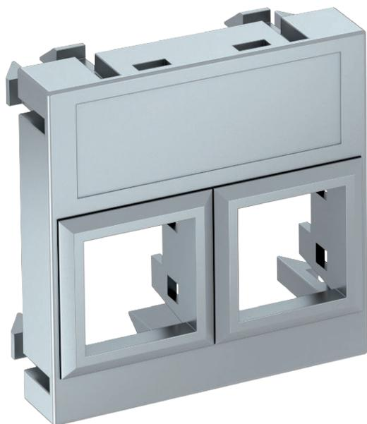
Корпус компьютерной розетки с прямым кабельным выводом, без шторок, для установки 2 гнездовых телекоммуникационных модулей RJ45. Установочный размер изделия: 45x45 мм. Растровое крепление предусмотрено для вертикального и горизонтального монтажа. В корпусе LE расположена специальная пластина для непрямого монтажа телекоммуникационных модулей.
