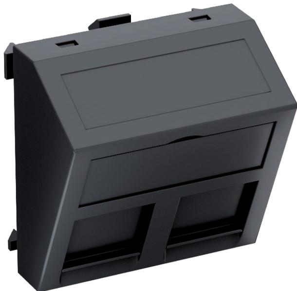
Корпус компьютерной розетки с наклонным кабельным выводом и шторками для крепления двух телекоммуникационных модулей с гнездом RJ45. Установочный размер изделия: 45x45 мм. Растровое крепление подходит для вертикального и горизонтального монтажа в системном отверстии. Тип EP имеет специальное монтажное основание для размещения встраиваемых модулей и предназначен для непрямого крепления модулей подключения к системам передачи данных в монтажном отверстии.
