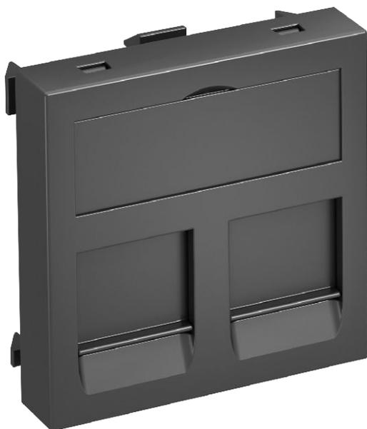
Корпус компьютерной розетки с прямым кабельным выводом и шторками, для установки 2 гнездовых телекоммуникационных модулей RJ45. Установочный размер изделия: 45x45 мм. Растровое крепление предусмотрено для вертикального и горизонтального монтажа. В корпусе EP расположена специальная пластина для непрямого монтажа модулей.
