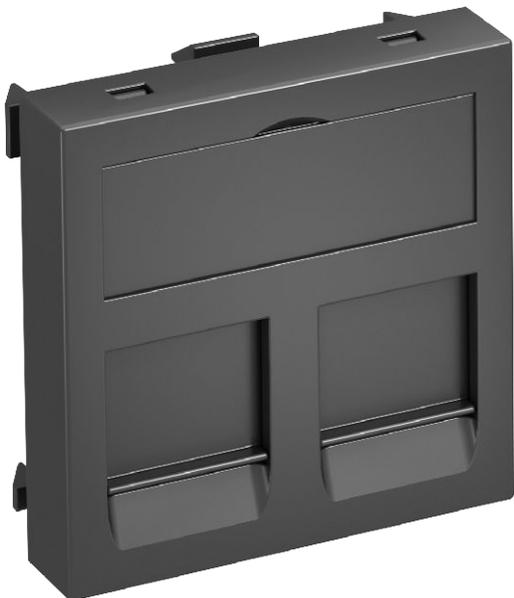
Корпус компьютерной розетки с прямым кабельным выводом и шторками, для установки 2 телекоммуникационных модулей RJ45. Установочный размер изделия: 45x45 мм. Растровое крепление предусмотрено для вертикальной и горизонтального монтажа. В корпусе В расположено отверстие 19,35/21,55 x 14,85 мм для прямого монтажа модулей.
