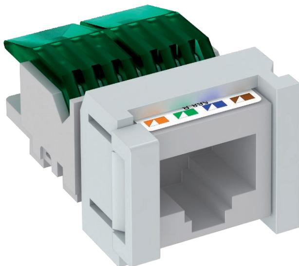
Телекоммуникационный модуль Cat 5е, неэкранированный, с одним разъемом RJ45. С пылезащитным колпачком, крепежной рамкой Snap-In и руководством по монтажу. Подходит для установки в суппорте MTM 2С и MTM 3С, в монтажной пластине MPR2 2С, монтажных рамках MTGE2 2С, MTGE2 15 2С и MTGE2 F 2С.
