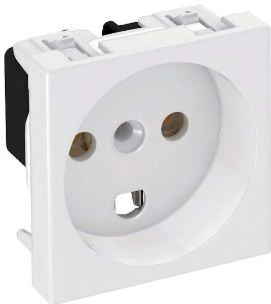
Одинарная розетка 0°, датский стандарт, с защитными шторками, с 2-полюсными винтовыми клеммами, 16 А, 250 V~, с соединительными клеммами согласно МЭК 60884-1.
