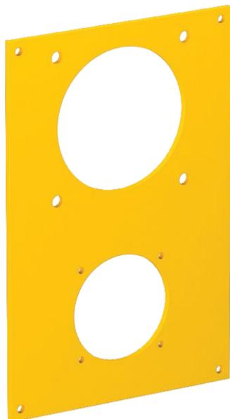
Накладка с отверстием  $\varnothing$  45 мм для установки одной розетки (тип ASD...) с крепежным пазом 38 мм и отверстием  $\varnothing$  60 мм для установки розетки CEE 16/32 A с крепежным пазом 60 мм, в комплекте с 8 крепежными болтами.
