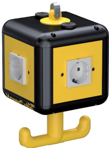
Укомплектованный блок питания с ручкой, крючком и 4 платами. Комплектация: с 4 одинарными розетками с защитным контактом 16 А/250 В, с защитными шторками, с соединением на 2 цепи переменного тока, подключение через две 3-полюсные клеммы, с разделительной перегородкой для разделения цепей тока.
