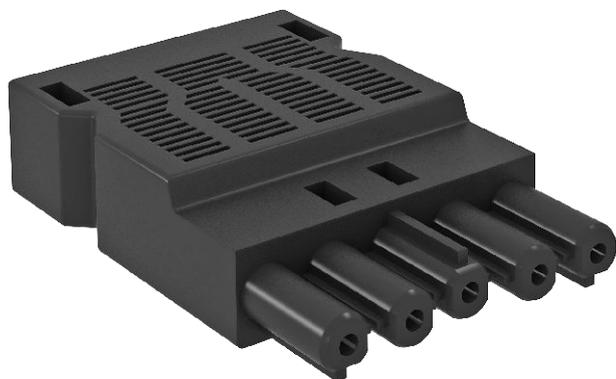
Гнездовой адаптер 5-полюсный GST 18i, с винтовым соединением, для одно- и многожильных проводов 1,5 - 2,5 мм<sup>2</sup>, с фиксатором для разгрузки кабеля от натяжения, 1 разъем на полюс, для проводов H05VV (Ø 9,5 - 13,5) и NYM (Ø 10,5 - 13,5 мм), 250 В, 16 А; Длина удаления оплетки: 8 мм; длина удаления изоляции: 46 мм.
