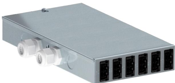
Вход: 2 трехфазные цепи через клеммный блок без винтов, 5-полюсный для сечения провода 0,5–4 мм<sup>2</sup>.
