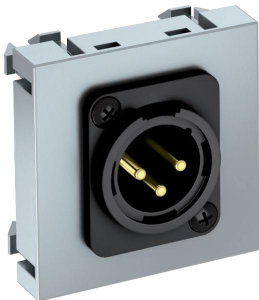
Мультимедийная рамка с разъемом XLR, с прямым выводом, без поля для маркировки, 3-х полюсный штекерный разъем с винтовыми клеммами. Суппорт с растровым креплением подходит для горизонтального и вертикального монтажа.
