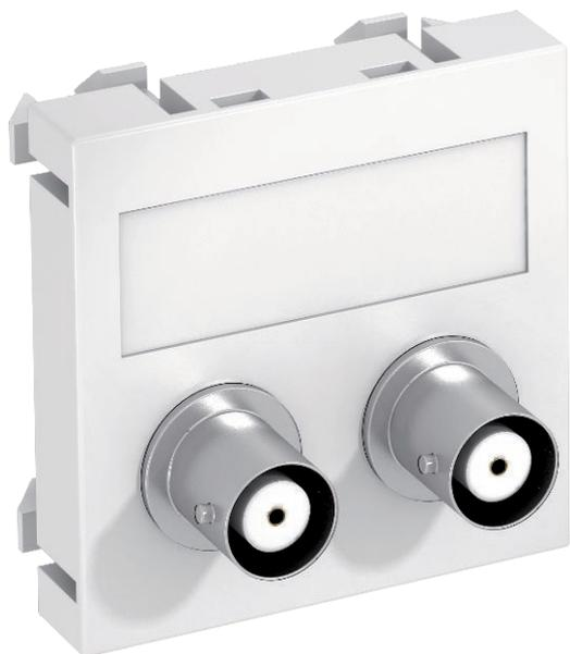
Мультимедийная рамка с двумя разъемами BNC, с прямым кабельным выводом, с полем для маркировки, два соединения BNC с разъемом 1:1 (гнездо-гнездо). Суппорт с растровым креплением подходит для горизонтального и вертикального монтажа.
