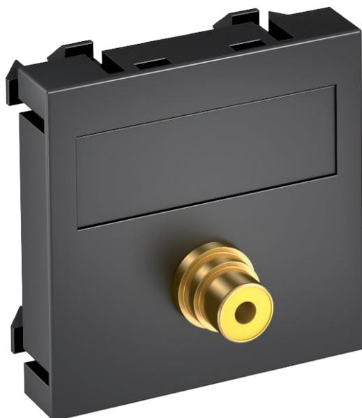
Корпус с разъемом «тюльпан» для Composite Video, прямой кабельный вывод, с полем для надписи, гнездо «тюльпан» (RCA) с подключением пайкой, цветовая кодировка желтая. Суппорт с растровым креплением подходит для горизонтального и вертикального монтажа.
