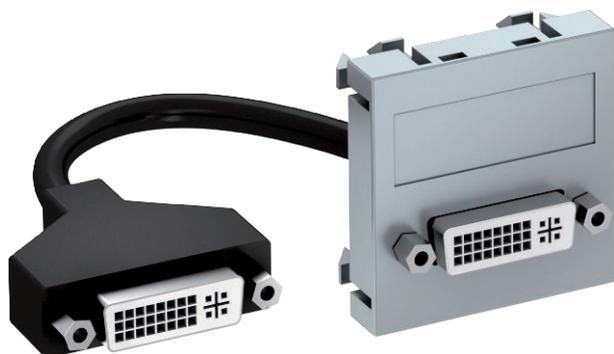
Разъем с гнездом DVI-I, прямой кабельный вывод, с полем для надписи, короткий соединительный кабель DVI-I в исполнении гнездо-гнездо. Суппорт с расстрывым креплением подходит для горизонтального и вертикального монтажа.
