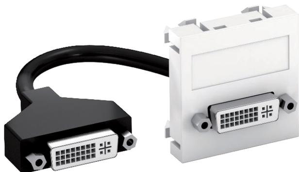
Мультимедийная рамка с разъемом DVI-I, с прямым кабельным выводом, с полем для маркировки, короткий соединительный кабель DVI-I с разъемом 1:1 (гнездо-гнездо) Суппорт с растровым креплением подходит для горизонтального и вертикального монтажа.
