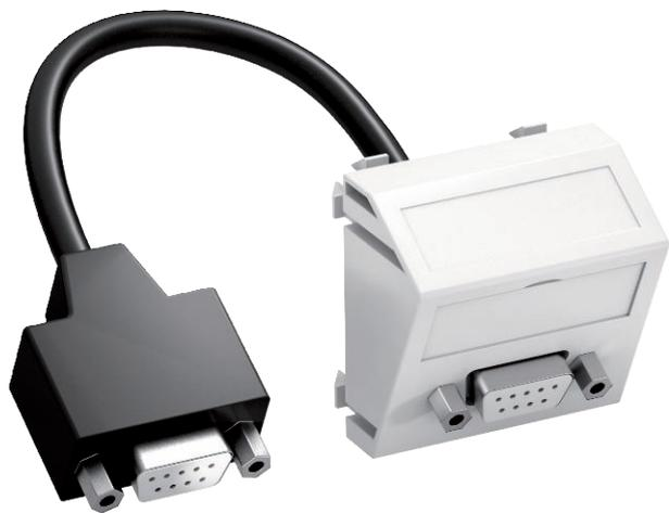
Мультимедийная рамка с разъемом D-Sub9, с наклонным кабельным выводом, с полем для маркировки, короткий соединительный кабель D-Sub9 (RS232) с разъемом 1:1 (гнездо-гнездо). Суппорт с расстровым креплением подходит для горизонтального и вертикального монтажа.
